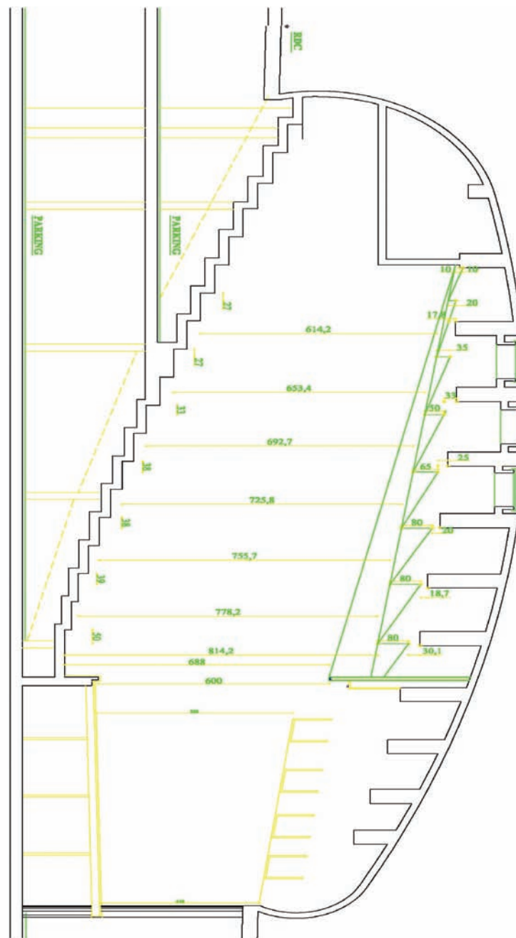
COUPE longitudinale faux plafond ech: 1/100
